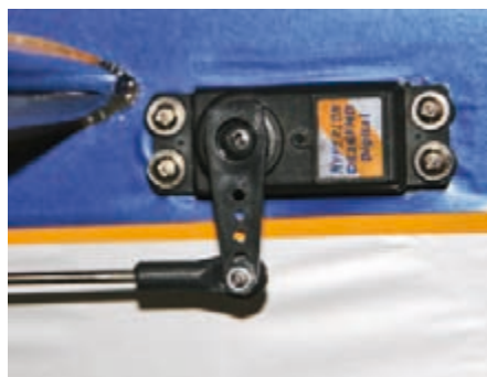
Um die Schwerpunktlage ohne Blei zu erreichen, wurden leichte Höhenruderservos eingesetzt.
