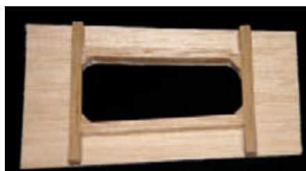
Zur Kühlluftabfuhr wurde der Rumpfboden hinter dem Seitenruderservo geöffnet.
