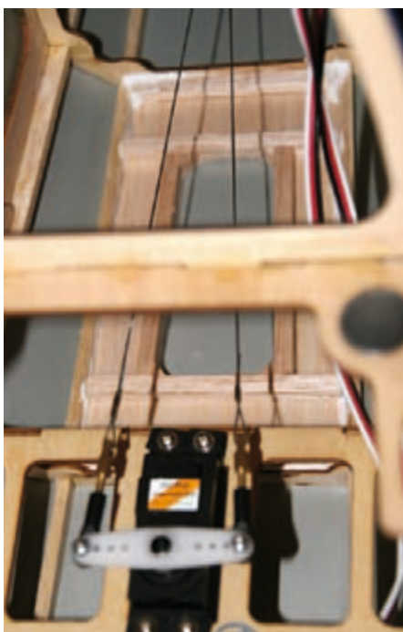
Zur Kühlluftabfuhr wurde der Rumpfboden hinter dem Seitenruderservo geöffnet.
